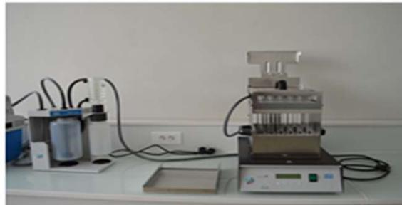
Digesteurs pour l'analyse des éléments de la plante sauf l'azote
