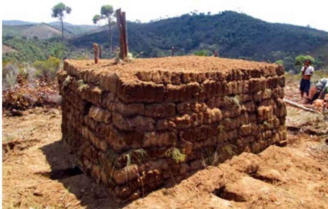
Photo 5. Meule après la phase de recouvrement par des matières végétales et des mottes de terres. On peut observer les événements d'aération sur le côté de la meule et d'allumage en face de l'emplacement de la bouche d'allumage qui n'est pas encore ouverte (les piquets ne sont pas encore enlevés). Commune d'Ambohibary.
