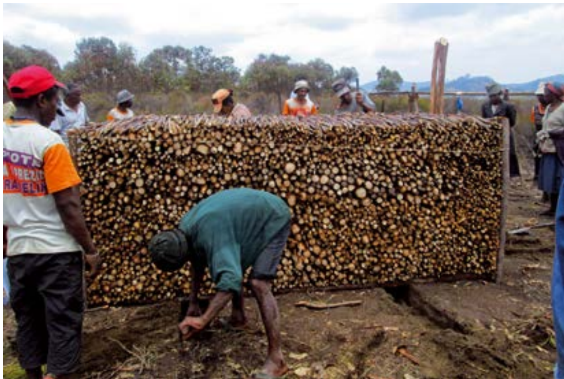
Photo 4. Meule VMTP après la phase d'empilement des bois et en cours de creusement des événements. On peut observer le lit de bois de petites dimensions en bas de la meule. Commune d'Ambohibary.
