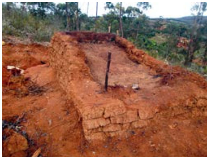
Photo 6. Meule éteint en cours de refroidissement. On peut observer les événements bouchés et la partie supérieure de la meule, affaissée. Commune de Ambohibary.
